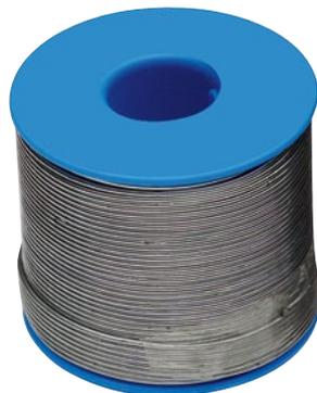
Lötendraht, spezielles, leicht fließendes Elektroniklot, das schnell erstarrt und Überhitzung vermeidet. SN 60, Pb 39, Cu 1, DIN EN ISO 9458, mit Kolophonium-Flussmittel.
