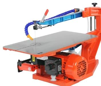
610 x 290 x 320 mm h, Motor 230 V/100 W, mit **elektronisch stufenloser Drehzahlre- gelung** 400–1400 U/Min, 2 Sägehübe: 12 und 19 mm, Schnitthöhe: 65 mm, Längsdurchgang: 460 mm, Sägetisch: 435 x 230 mm, 45°/12° schwenkbar.
