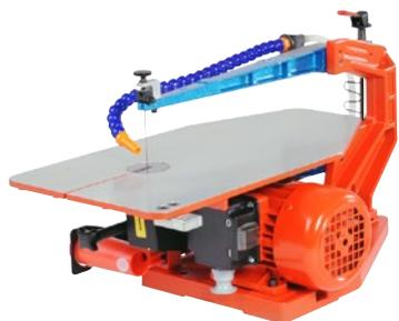
520 x 285 x 280 mm h, Motor 230 V/100 W, 1400 U/Min, 2 Hübe: 15 und 12 mm, Schnitthöhe: 50 mm, Längsdurchgang: 365 mm, Sägetisch: 435 x 230 mm, 45° schwenkbar. Zentraler Anschluss Ø 35 mm für obere und untere Staubabsaugung. Gewicht: 16 kg
