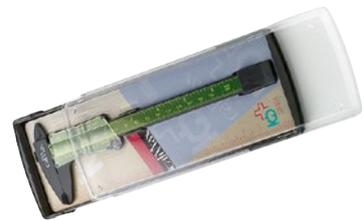
Schieblehre mit Nonius: 9-teiliger Hilfsmassstab, der zusammen mit dem 10-teiligen Hauptmassstab das Ablesen von Dezimalstellen des Hauptmassstabs erlaubt. Differenz zwischen Einheit des Hilfs- und des Hauptmassstabs = 1/10.
