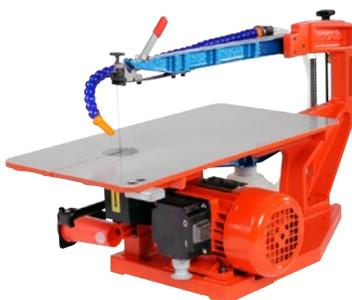
610 x 290 x 320 mm, Motor 230 V/100 W, 1400 U/Min, 2 Sägehübe 12 und 19 mm, Schnitthöhe: 65 mm, Längsdurchgang: 460 mm, Sägetisch: 435 x 230 mm, 45°/12° schwenkbar.
