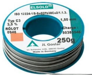
Starker Lötendraht. Der hohle Lötendraht ist mit Kolophonium gefüllt. Bei erhöhter Temperatur spalten sich vom Flussmittel Säuren ab, welche die dünne Oxydschicht von der Oberfläche lösen. Das blanke Metall wird nun vom Lot richtig benetzt und kann sich so dauerhaft verbinden.
